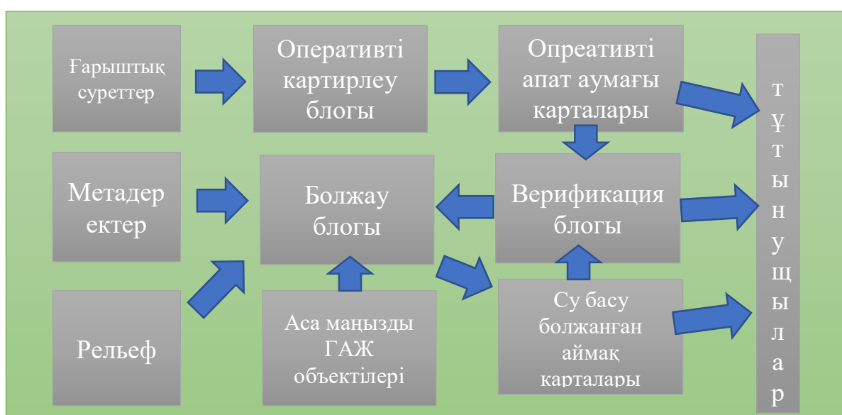
3.4 Сурет – Су тасқыны мен су тасқыны ғарыштық мониторингінің құрылымдық схемасы
